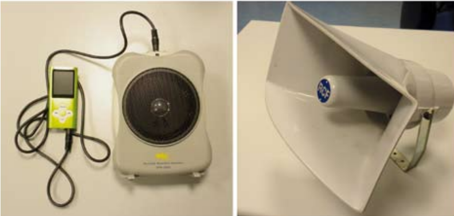
Strumentazione impiegata per il monitoraggio mediante playback. La riproduzione dei richiami viene effettuata mediante un lettore mp3 collegato a un amplificatore portatile (6-10 W) alimentato a batterie (sinistra). Per le emissioni realizzate da autovettura è possibile utilizzare un diffusore passivo (destra)
