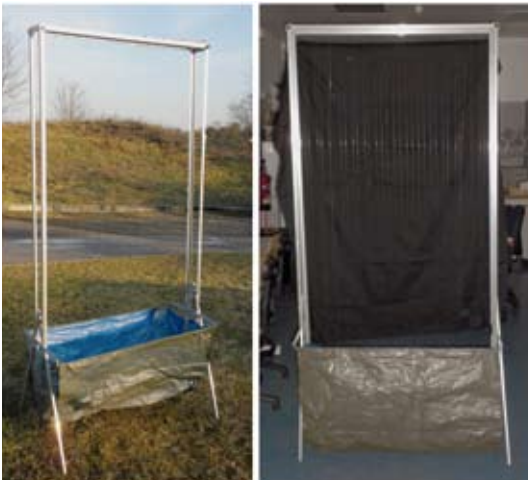
Harp-trap per la cattura di Chirotteri. Gli animali in volo colpiscono i fili della trappola e cadono nella sacca posizionata nella parte inferiore
