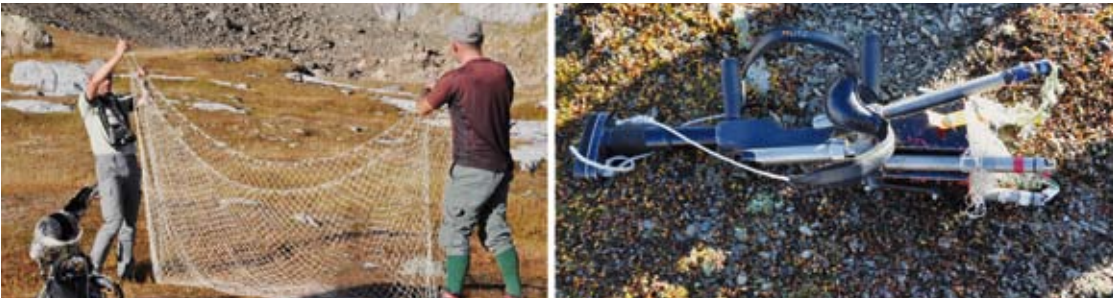
Preparazione di una gun net. La rete viene piegata (a sinistra) e inserita nell'apposito fucile lancia-rete (a destra)
