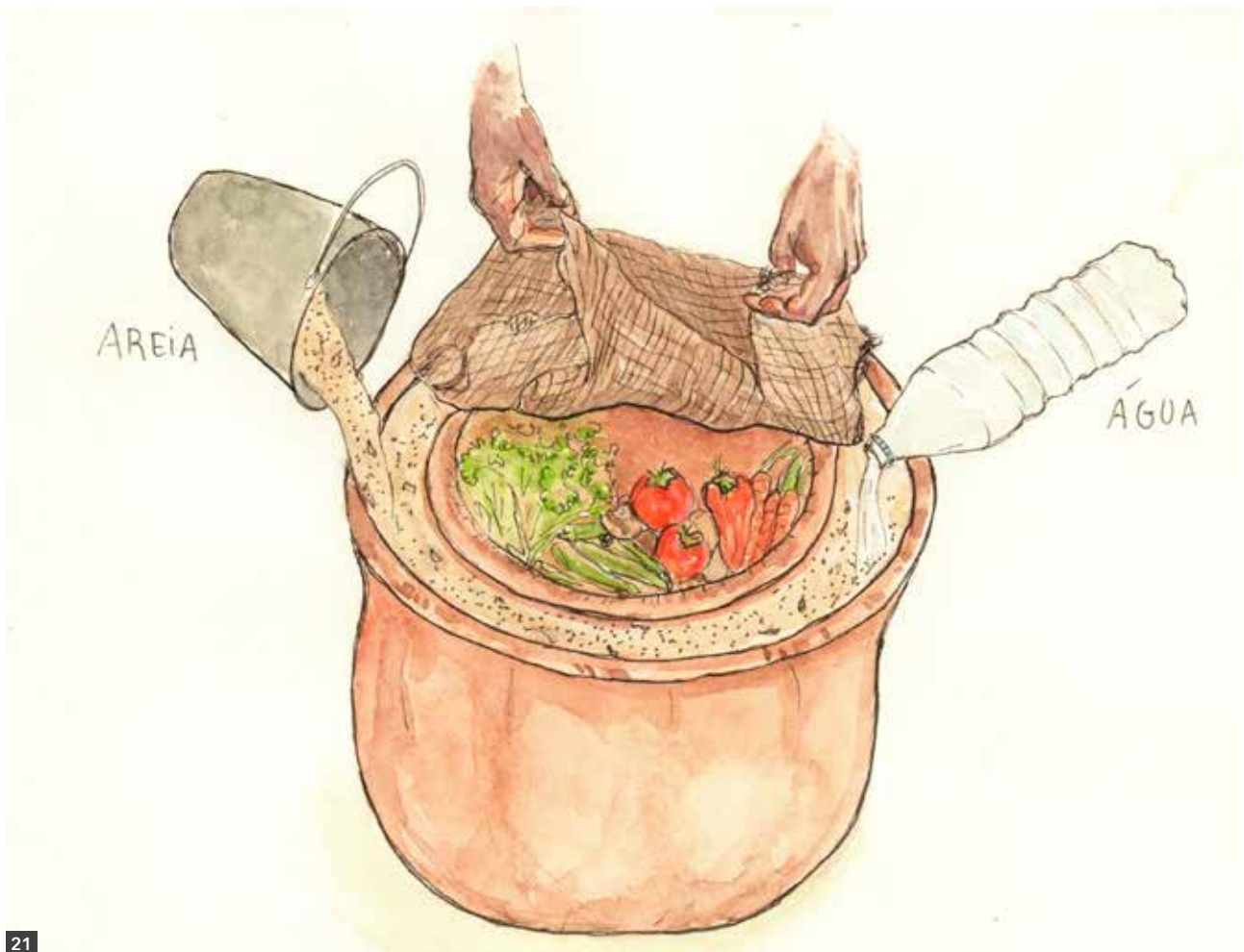
Fig. 21 Panelas de barro em função segundo o sistema zeer pot para manter a uma temperatura e humidade ideais para conservar os produtos colhidos em zonas sem a eletricidade. Só precisa-se duas panelas de barro, areia, um saco de sisal e água.
